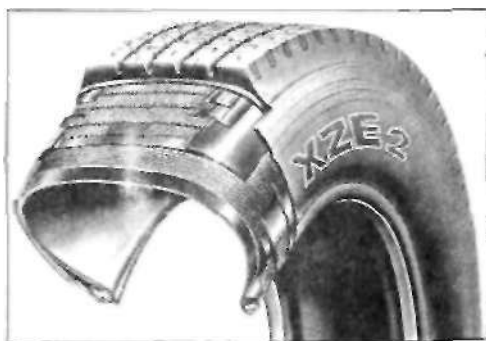
Шина для оси с управляемыми колесами: продольно ориентированный профиль, важен боковой увод.
