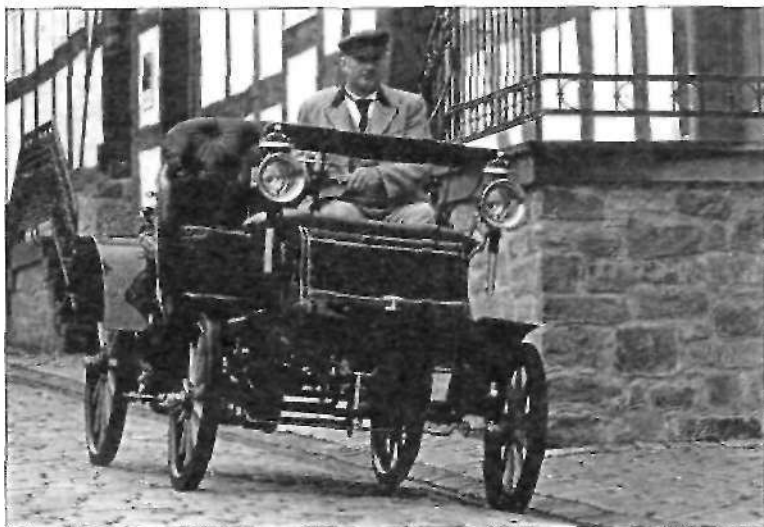
Моторные автомобили: Опель (система Лутцмана (Lutzmann)) в 1899 г. ездил еще на шинах из сплошной резины.
