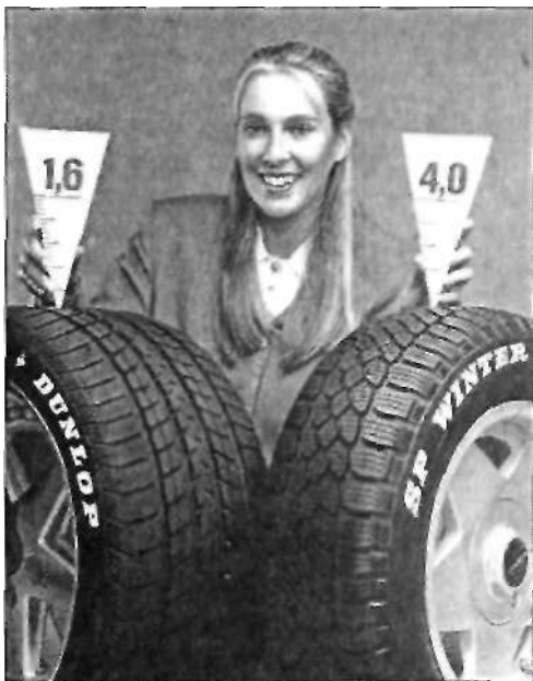
Минимальная глубина профиля: в летних шинах разрешается иметь глубину профиля 1,6 мм, в зимних шинах она должна быть 4 мм.
