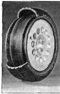
Michelin PAX: новая система колесо/шина, здесь с дополнительным опорным кольцом на ободе..
