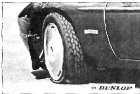
Поломка в дороге: с обода ТО шина остается на месте.
