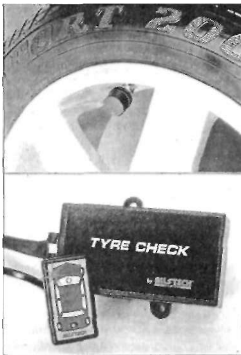
Простое решение: колпачок клапана с сенсором давления, передающим и приемным устройствами и блоком управления.
