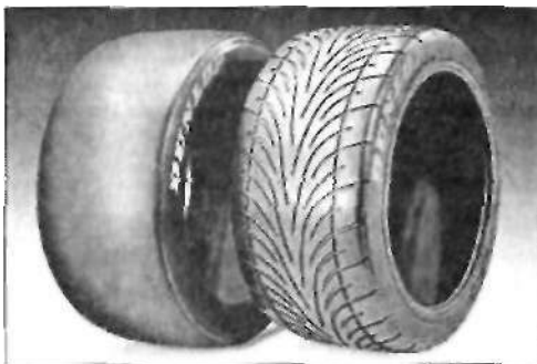
Шины для кольцевых гонок: Dunlop разработал беспрофильную шину и шину для дожде (дизайн: SP 9000).
