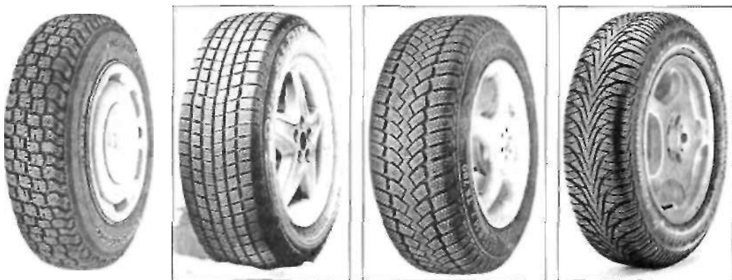
Зимние шины: более старая модель и современная продукция компании Michelin (Alpin), Conti (TS780), Goodyear (Ultra Grip 6) с эффективными резиновыми смесями и ламелированным профилем.
