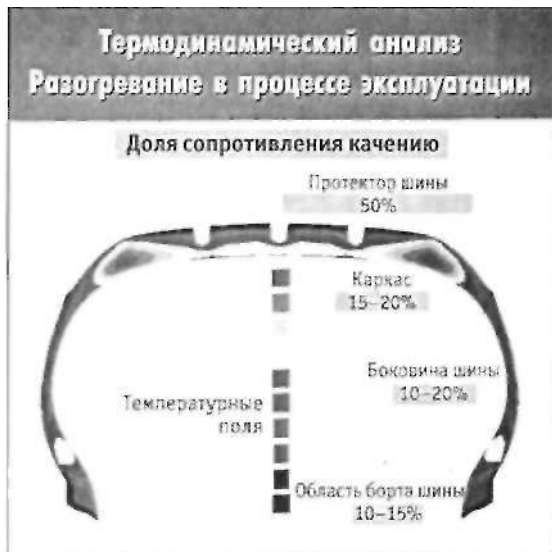
Сопротивление качению: каждый элемент шины вносит свою долю, но особенно большую - протектор.
