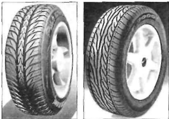
Варианты профиля: слева профиль, увязанный с направлением движения, справа асимметричный.
