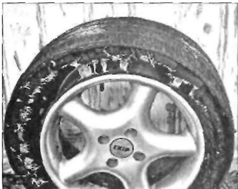
Дефект: каркас на боковой пенке полностью разрушился, косвенный дефект.
