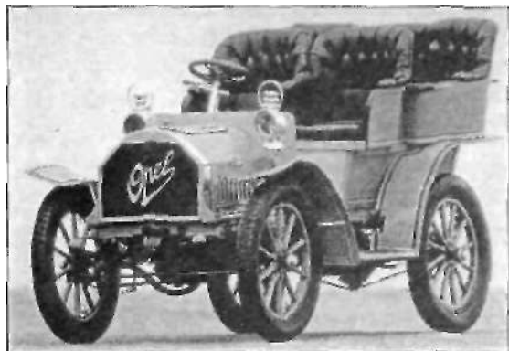
Новое время: реставрированный автомобиль с двигателем мощностью 12 л,с, колеса были с деревянными спицами и профильными шинами.
