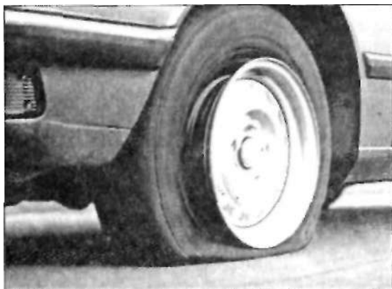
Даже короткие поездки со спущенными шинами могут разрушить их внутреннюю структуру.
