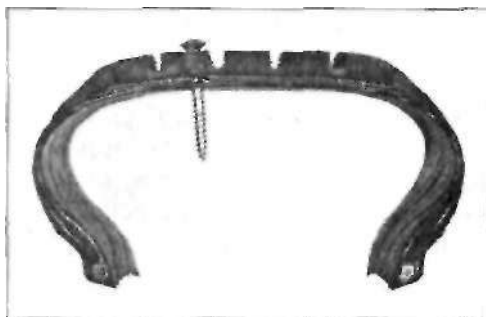
Убедительный «успех»: при таком повреждении шину нужно заменить.
