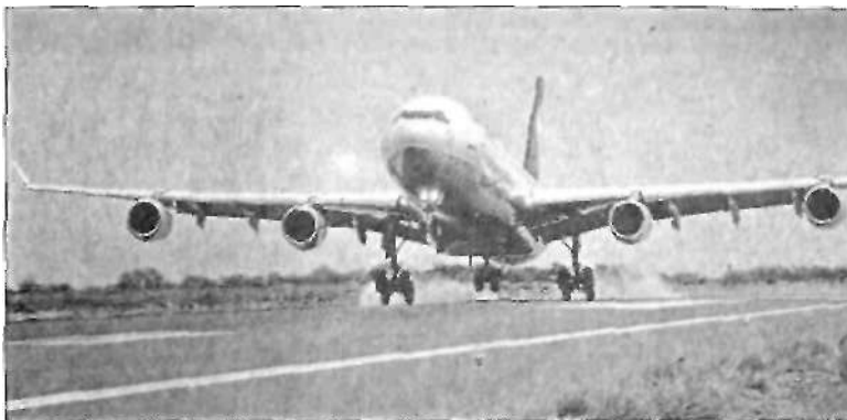
Приземление: аэробус А340-200 »о «реп» прюечпеим, колеса ускоряйте» от 0 до 250 км/час.
