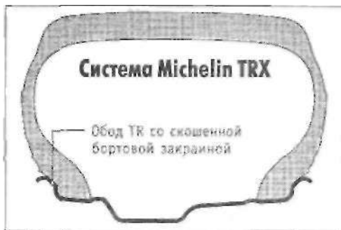
TRX специальный борт и бортовая закраина, на спнема тоже не получило большого признанна.
