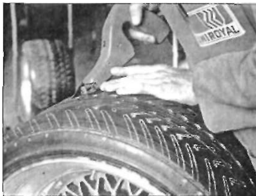
Резчик профна шкн: профиль первых испытательных образцов делается вручную.
