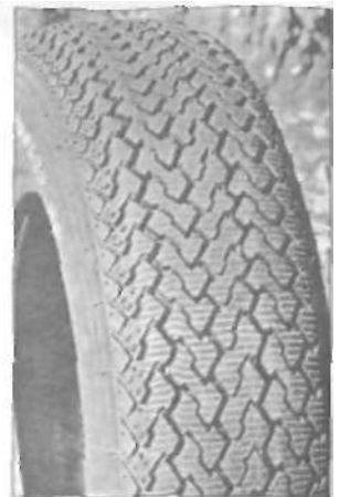
Зимняя шина Dunlop: вместо шипов в профиль вулканизировалась проволока.
