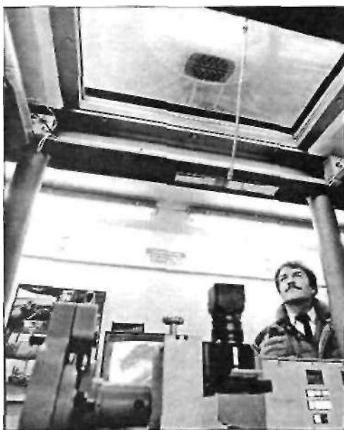
Аквапланкованне: стеклянная пластина с пленкой воды показывает поведение шины (слева и справа).
