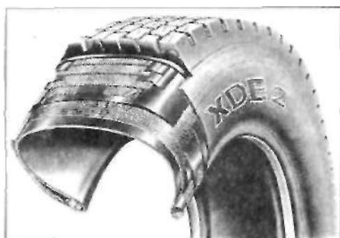
Тяговые шины: дизайн профиля ориентирован на перенос мощности привода.
