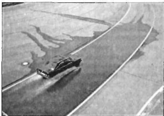
Теп шины: продольное аквапланирование (движение по прямой) и поперечное аквапланирование (на поворотах).
