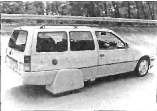
Лаборатория по экспертизе шин: измерение характеристик шин, например сопротивления качению у Opel.
