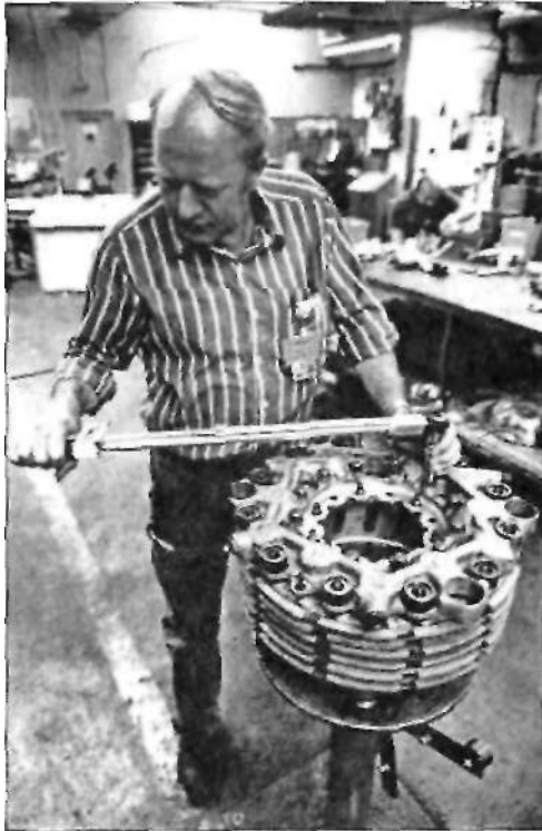
Тормоза самолета: пакеты с несколькими тормозными дисками обеспечивают высокий уровень торможения.
