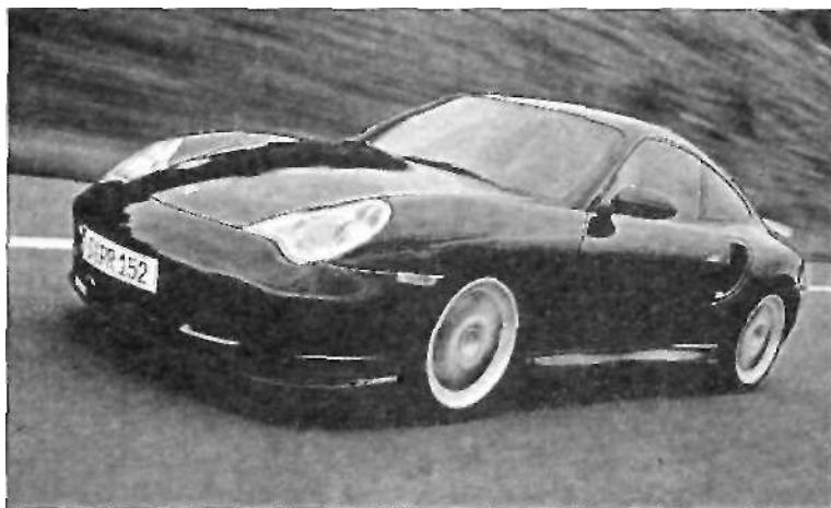
Porsche Turbo: высокопроизводительные шины выдерживают мощность привода в 420 л. с. и мощность торможения в 1680 л. с.
